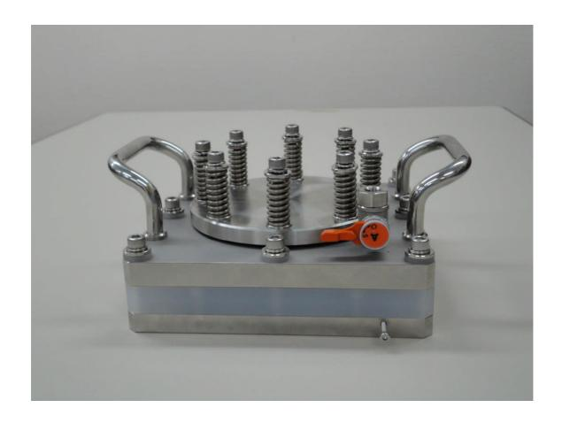
このセルは、大きな電極で電気化学測定を行う為のセルです。
