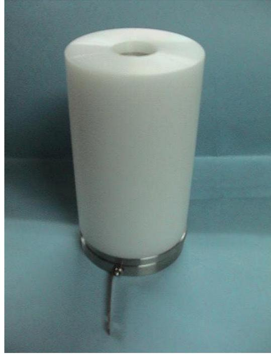
このセルは、荷重を表示（又は設定）できるプレス機等で、粉体に荷重をかけながら、その電気伝導度を測定する為のものです。
