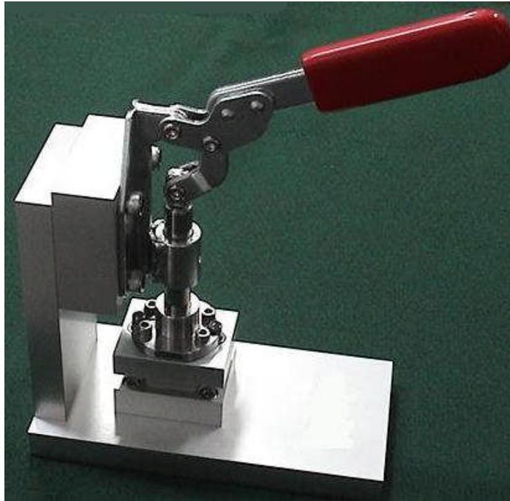
金属リチウムを打ち抜く為に、特殊な抜き型を備えた打ち抜き機です。
