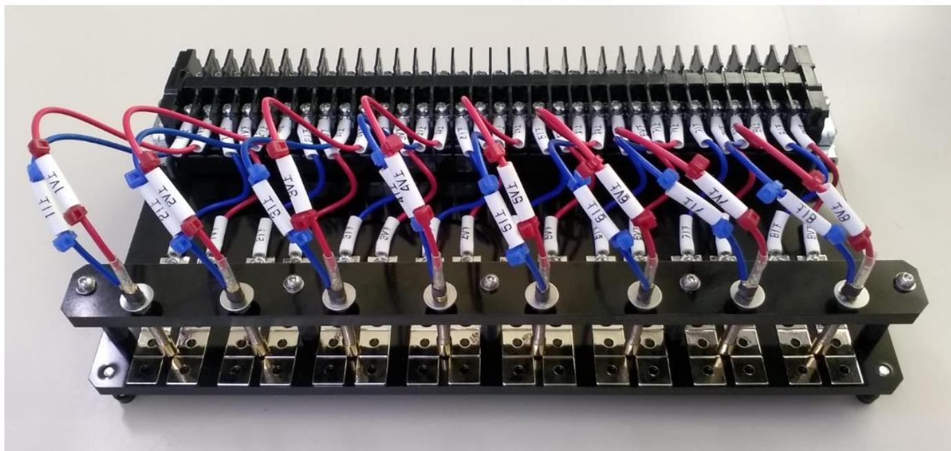
同軸プローブピンを持ち上げることで、コイン電池を水平に移動させることができ、容易に脱着出来ます
