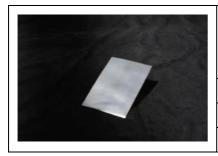
電池実験に使用するリチウム箔の標準品です。
