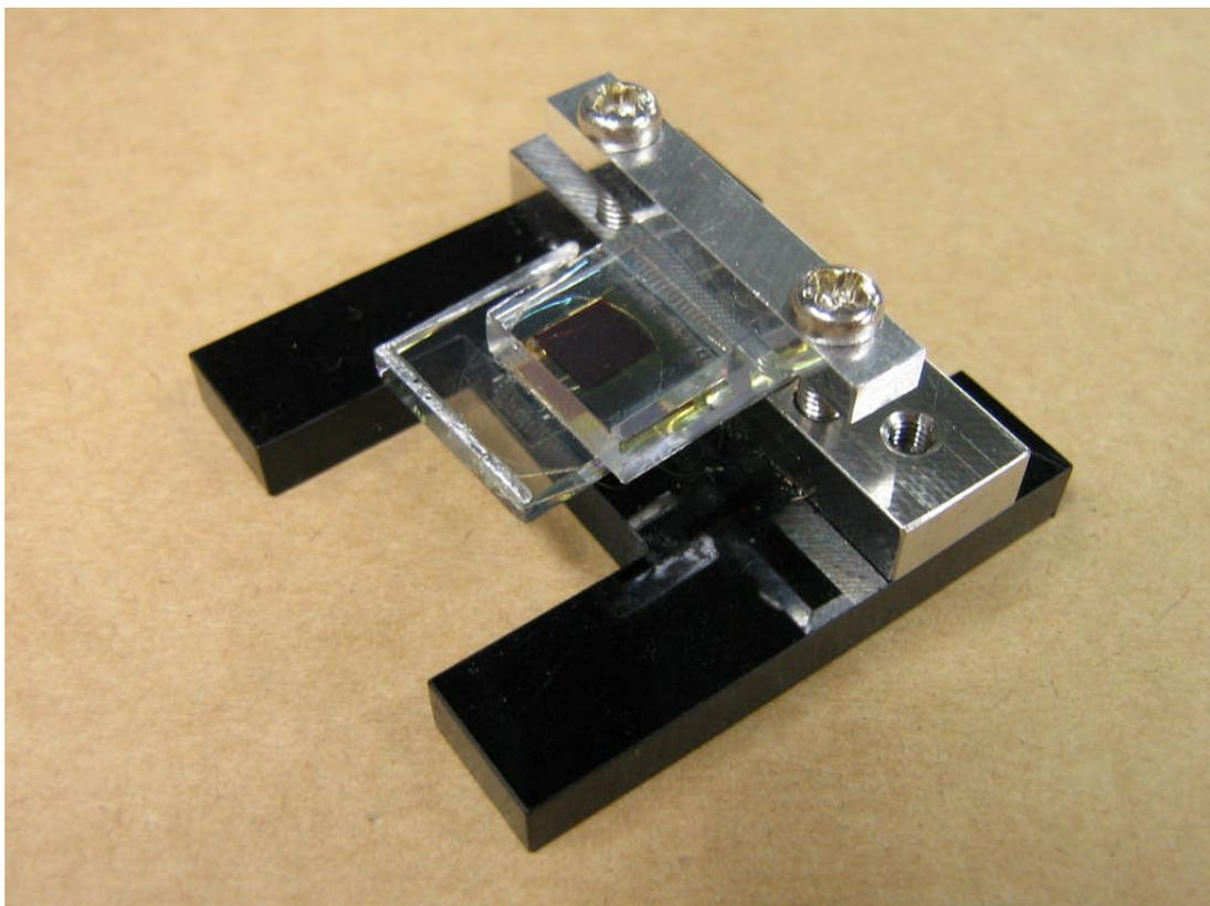
この治具は、試作した色素増感型太陽電池を固定し、測定装置との接続を容易にする為の治具です。
