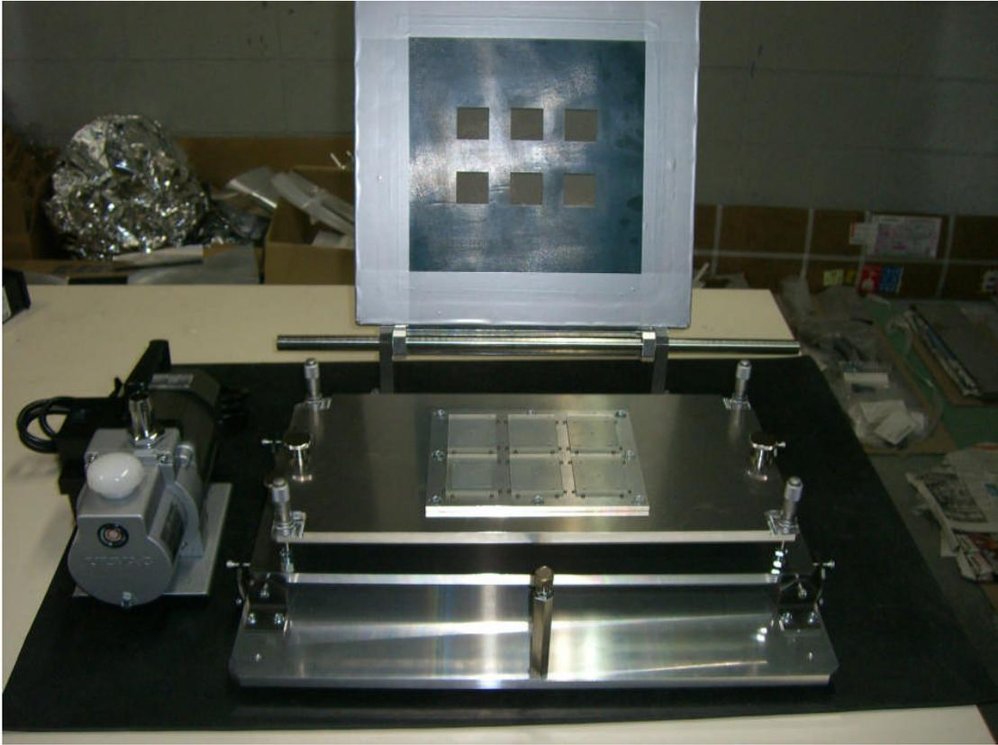
本装置は、パターンを形成されたナイロンやステンレス等の織物（スクリーン）の枠内に塗料をのせて、スキージで塗料をスクリーンの開口部から押し出して塗工（印刷）するものです。
